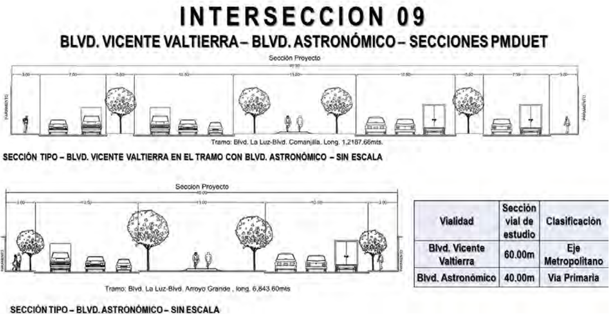
Figura 36, Sección vial intersección 9.
