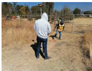
Figura 5, Levantamiento Topográfico con GPS (UTM).
