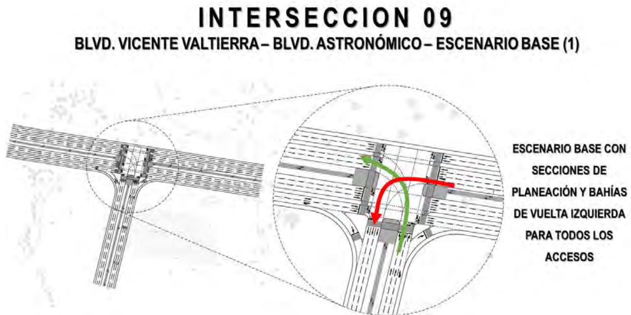
Figura 37, Propuesta geométrica Intersección 9.
