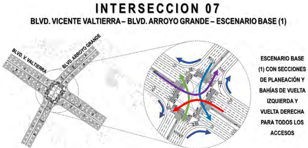
Figura 33, Propuesta geométrica Intersección 7.
