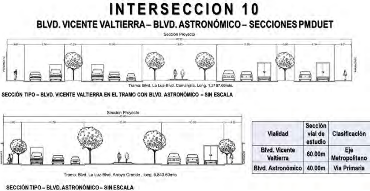
Figura 38, Sección vial intersección 10.
