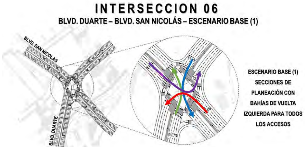
Figura 31, Propuesta geométrica Intersección 6.
