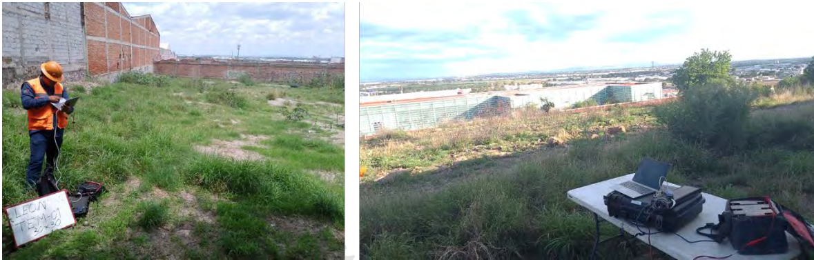
Figura. Tendidos de las líneas de las tomografías de resistividad eléctrica (TEM) Fuente: Elaboración propia en trabajos de campo.
